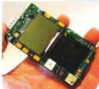
MachZ, un esempio di system-on-chip a bassissimo consumo (238 milliwatt a 128 MHz!), basato su un core Cyrix "586", fabbricato dalla National Semiconductor per conto della ZF Linux Devices. Comprende in un singolo chip: CPU, cache memory, PC core logic, boot ROM, funzioni di I/O, "north bridge" (interfaccia per il bus PCI bus), "south bridge" (interfaccia per il bus ISA), e logica di controllo della DRAM interfaccia. Per costruire un sistema funzionante è sufficiente aggiungere solamente la DRAM. In alto a sinistra la demo board.
